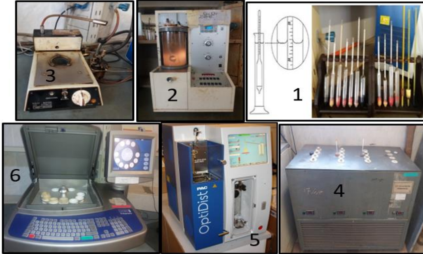
الشكل (3) الأجهزة المستخدمة في الاختبارات الكيميائية والفيزيائية للوقود الحيوي المنتج، (الكثافة، اللزوجة، الوميض، الانسكاب، عدد السيتان ومقدار الكبريت)
